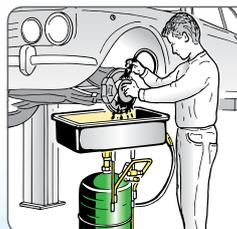
Lavage avec le pinceau à écoulement continu de liquide
