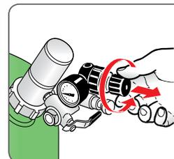
Le système pneumatique fonctionne à basse pression 0,5 bar, en consommant très peu d'air
